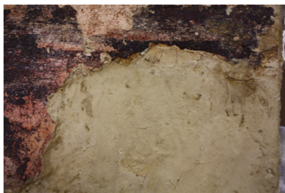
Imatge en que s'aprècia reintegracions de suport de tres naturals diferents: estuc de guix amb adhesiu acrílic en alta proporció, morter de calç i pols de marbre amb acetat de polivinil i Araldit Fusta mesclat amb pols de marbre. A la dreta, detall del clivellat que presentava la reintegració de les grans llacunes degut a l'excés d'adhesiu utilitzat.
